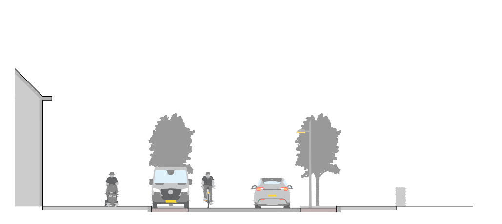
Dwarsprofiel D-D Nieuweweg t/h brs. 6/7 (huidge situatie)
