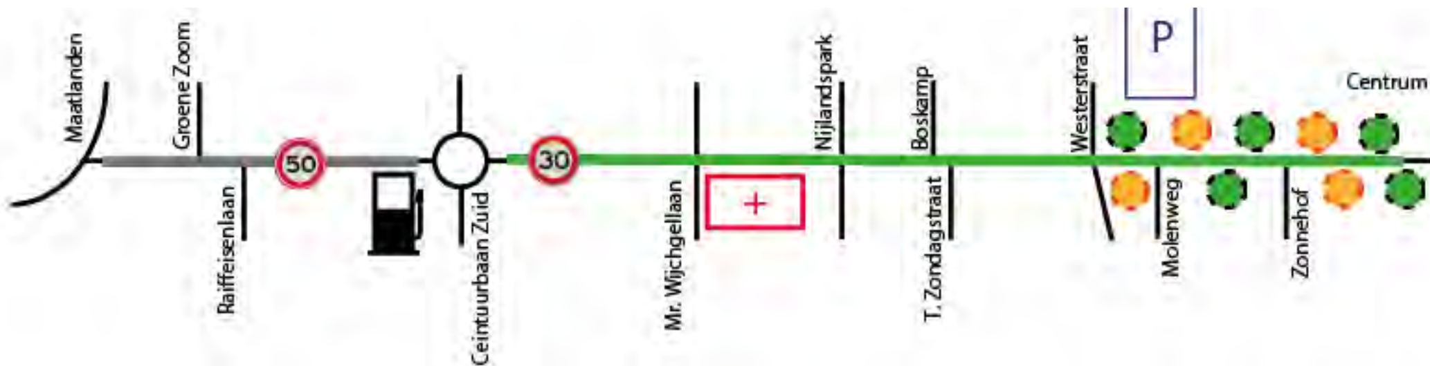
Overzicht snelheids- en inrichtingsprincipes ontwerp Nieuweweg
