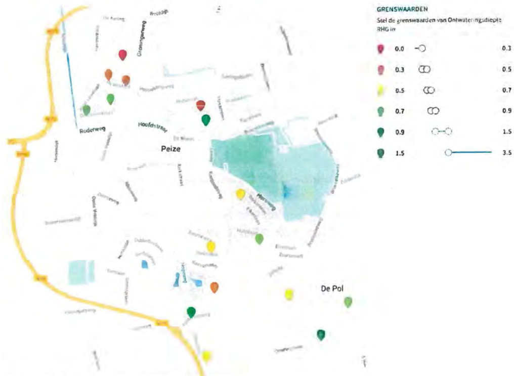
Figuur 13: Ontwateringsdiepte RHG t.o.v. maaiveld [7]
