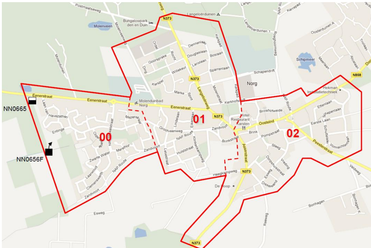
Figuur 3.4. Stuwgebieden riolering Norg met gemaal (NN0665) en overstort (NN0656F) met randvoorziening ( 450 \text{ m}^3 ) en aanvullende berging ( 2100 \text{ m}^3 ). Bron: BRP Norg door Grontmij Nederland, d.d. 28 februari 2012 met projectnummer 261230. De planontwikkeling Oosterveld ligt direct oostelijk van gebied 02.
