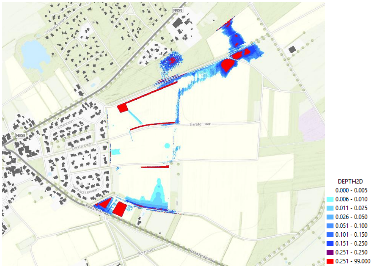
Figuur 6.3 Resultaat afstromings-analyse met gecombineerd riolerings- en maaiveldmodel, waterdiepte na 144 mm in 3 uur (4x bui 10 na elkaar). Waterdiepte in meters.
