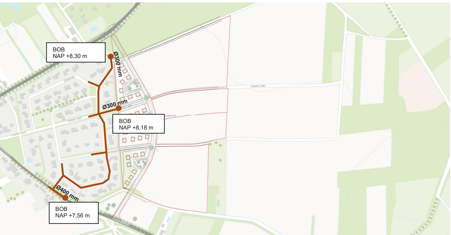
Figuur 3.5. Bestaande riolering met potentiële aansluitlocaties voor vuilwaterriolering Oosterveld. Diameter en hoogteligging van deze locaties zijn aangegeven.
