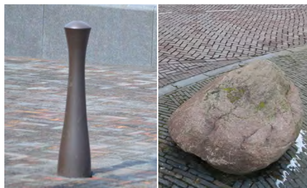
afzetpaal (Grijsen Cono) en zwerfkeien als markering en afzetelement
