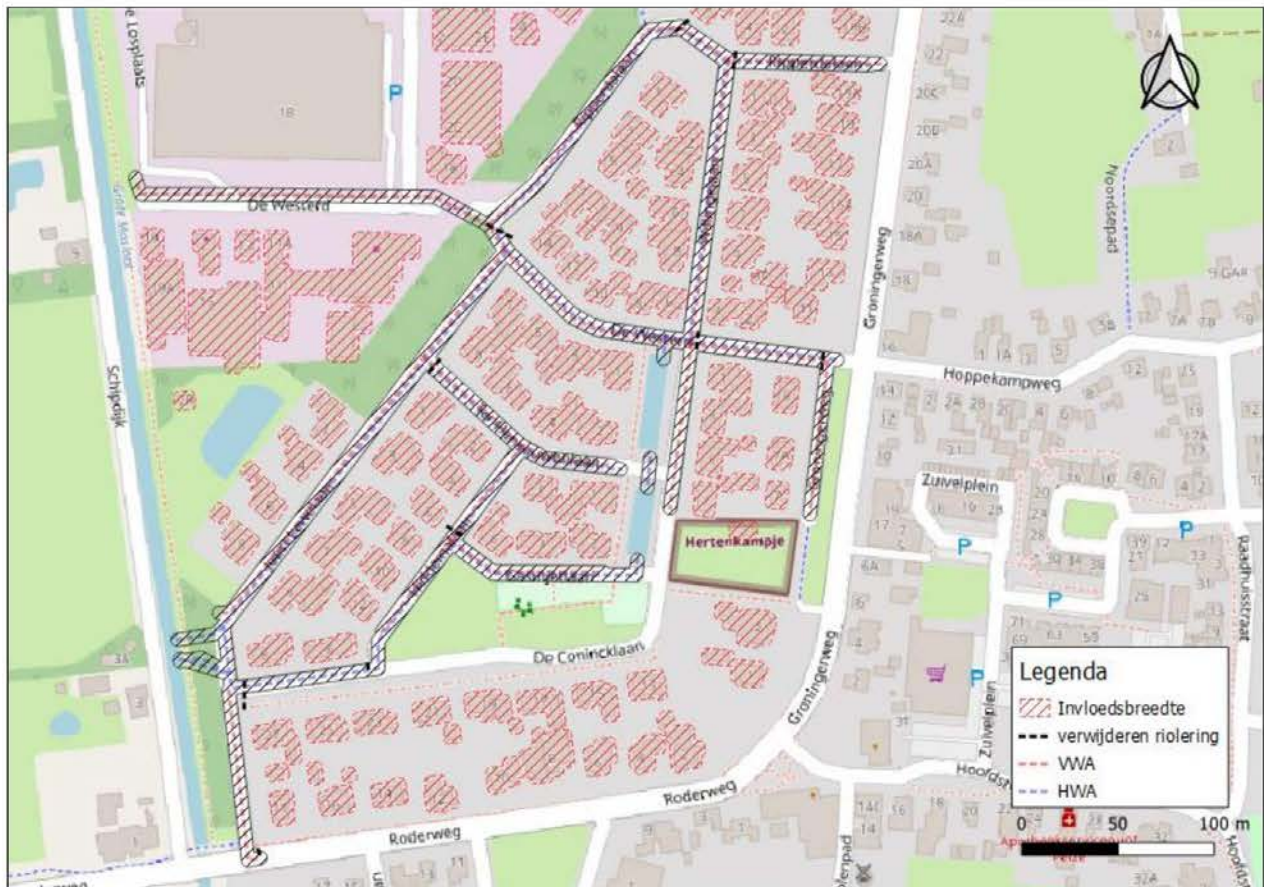
Figuur 6.4 Invloedsbreedte funderingsstroken en bouwputbreedte
